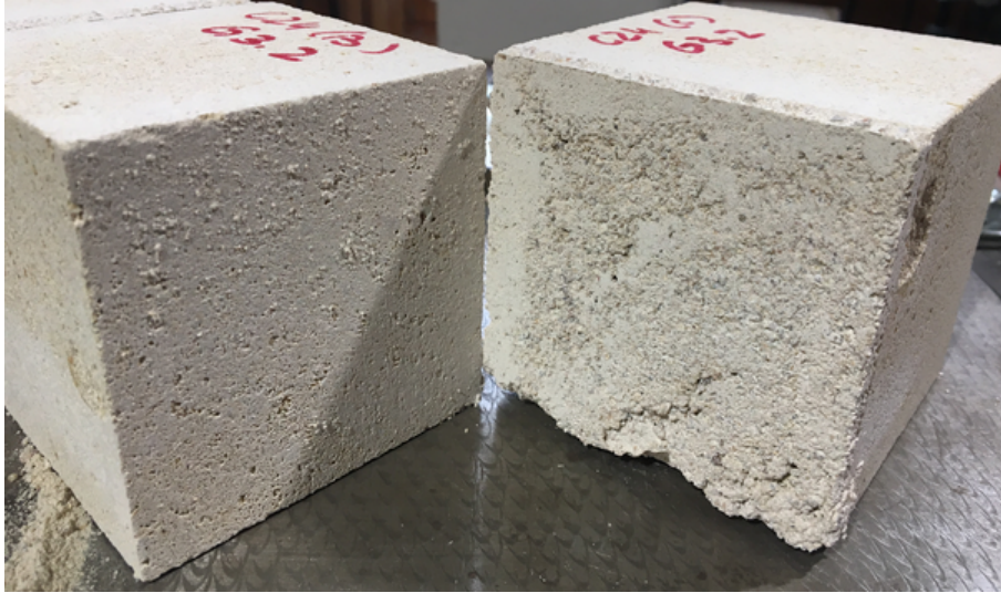
FIGURE 2.18 – Fissuration interfaciale observée lors des essais de cisaillement
