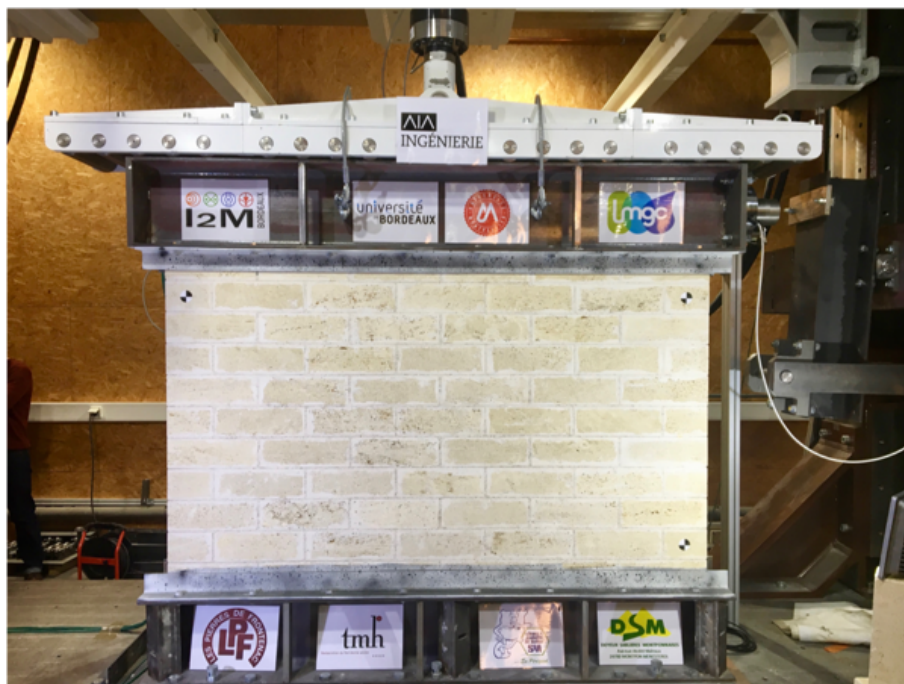
FIGURE 4.2 – Photographie du mur monté et appareillé
