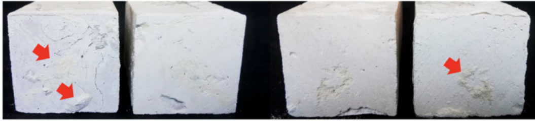
FIGURE 1.17 – Arrachement de pierre lors d’un essai de flexion 4 points sur primes (Karatasios et al., 2018)
