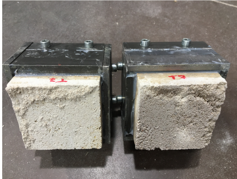
FIGURE 2.7 – Fissuration interfaciale observée lors des essais de traction
