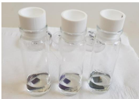
Figure III.5 : Substrat de Si recouvert par la nanostructure de \text{TiO}_2 immergé dans la solution de greffage contenue dans un pilulier.
