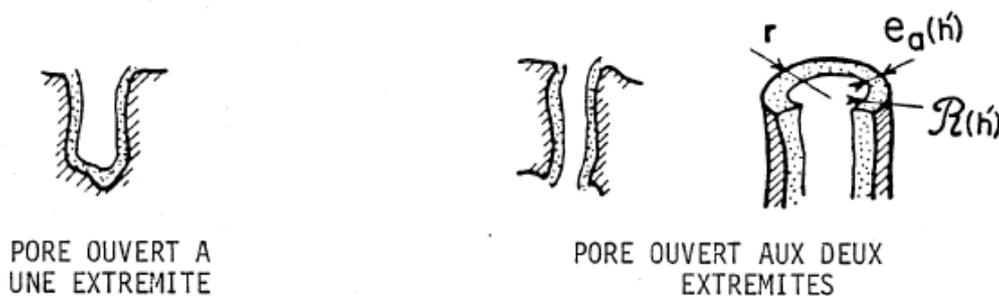
Figure 1-17 : Amorce de la condensation capillaire [26]
