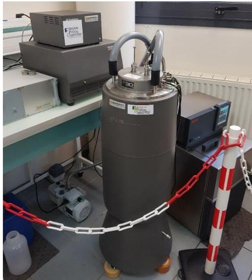
Figure 3-35 : Calorimètre Calvet BT 2.15
