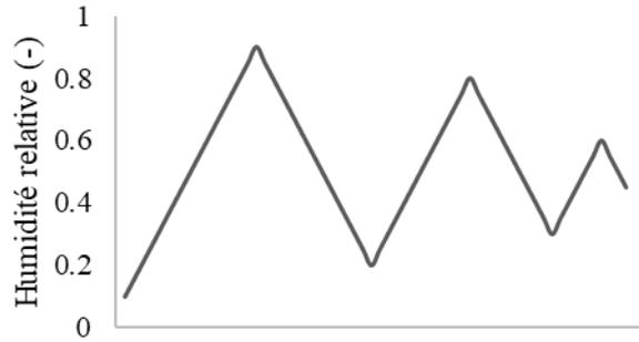
Figure 3-17 : Protocole de chargement hydrique
