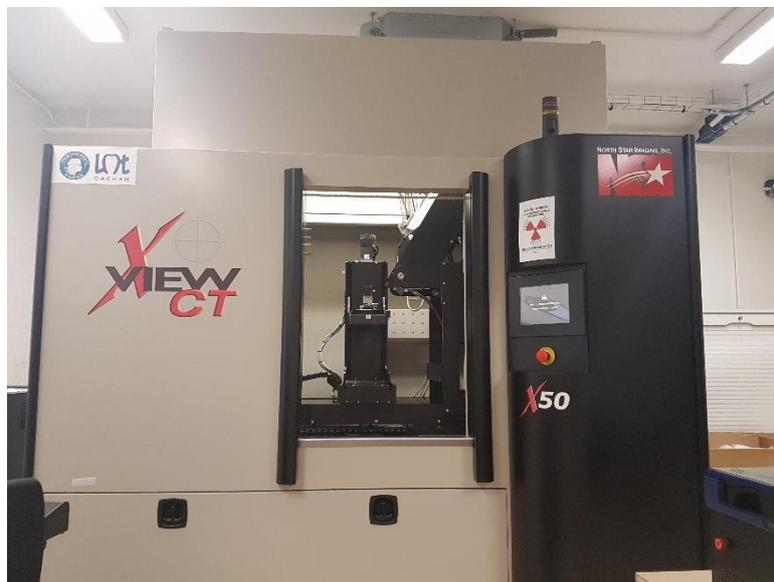
Figure 2-8 : Tomographe à rayons X utilisé au LMT Cachan
