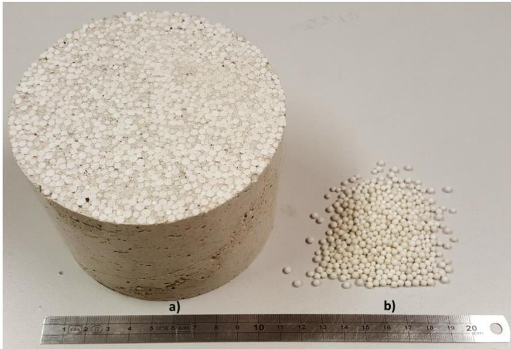
Figure 2-5 : Matériaux utilisés: a) mortier d'EPS; b) Billes de polystyrène expansé
