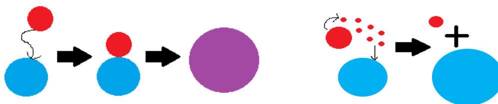
Figure I.28 – (a) Schéma du mécanisme de frittage par migration des particules métalliques et coalescence – (b) Schéma du mécanisme de frittage par vieillissement d'Ostwald
