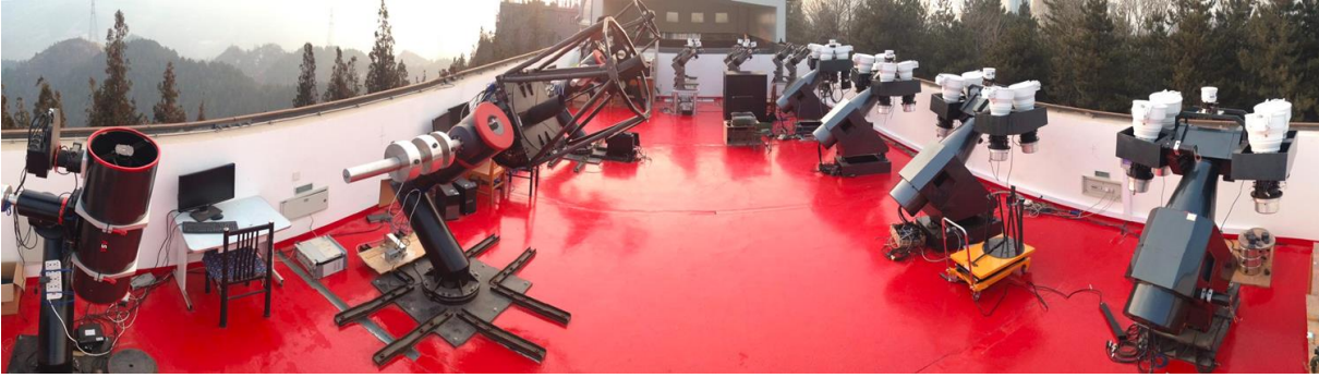
Figure 2.8 – Vue de l’ensemble GWAC à l’Observatoire de Xinglong (Chine) avec les montures de caméras à droite et les télescopes de 60 et 30 cm à gauche.
