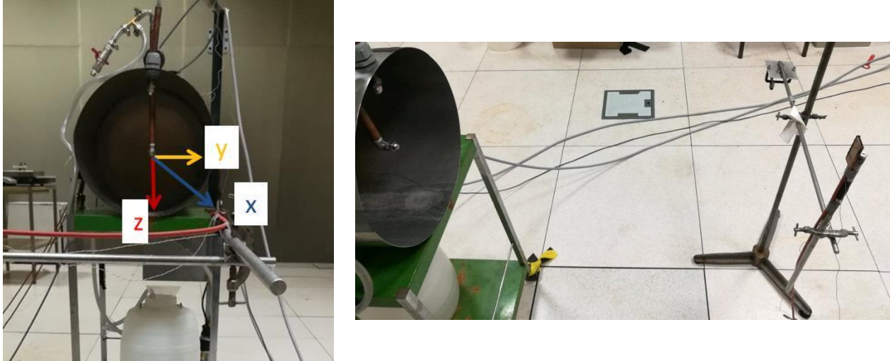
Figure IV.2.4: Repère considéré pour définir la position de la plaque par rapport à la buse
