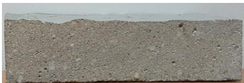
Figure IV.133 – Vue du profil du mortier formulé avec du latex CM-330 (P/C=0,1, cure sans séchage)
