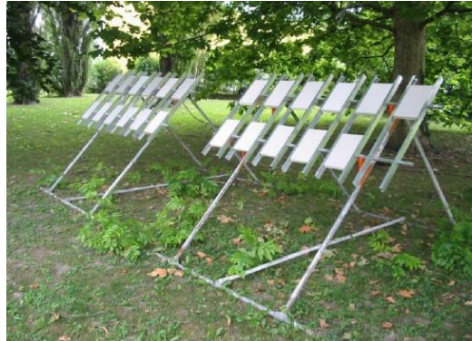
Figure I.38 – Essais de bioaltération, cas d'une exposition in-situ [TRAN11]
