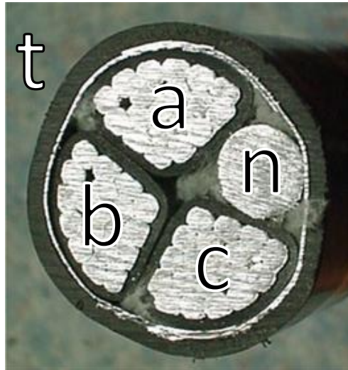
Figure 3.2 Coupe d'un câble BT français
