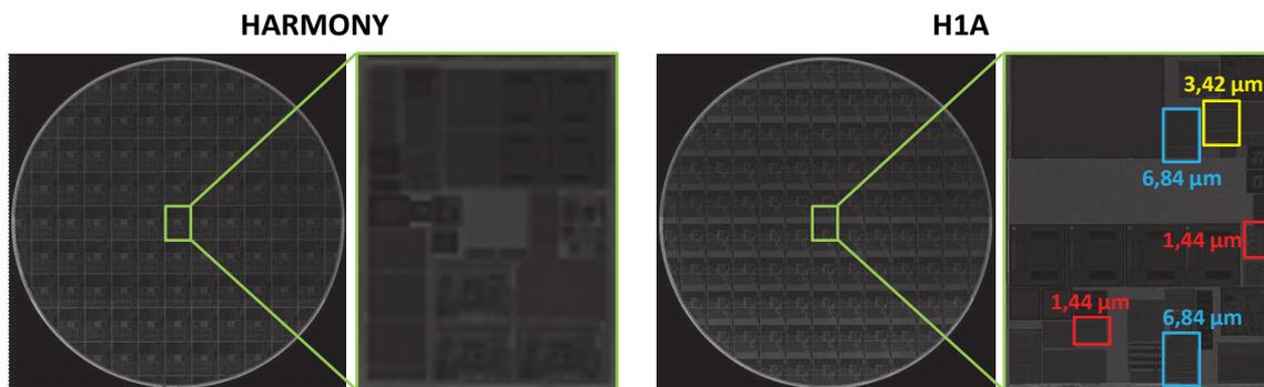
FIGURE 5.5 – Images SAM des plaques HARMONY et H1A avec zoom sur un champ. Les analyses sont réalisées après recuit de collage  $400^{\circ}\text{C}$ -2h.
