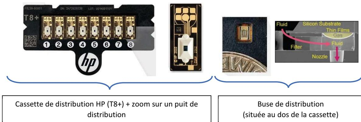
Figure 39 : Descriptif de la cassette de distribution utilisée pour le spotting
