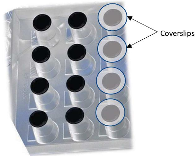
*Figure 50 : Support transwell® 24 puits adapté pour le spotting*
