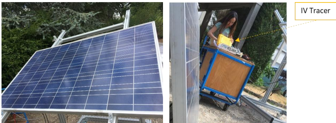
Figure 135 Campagne de mesures pour sélection des modules PV à installer
