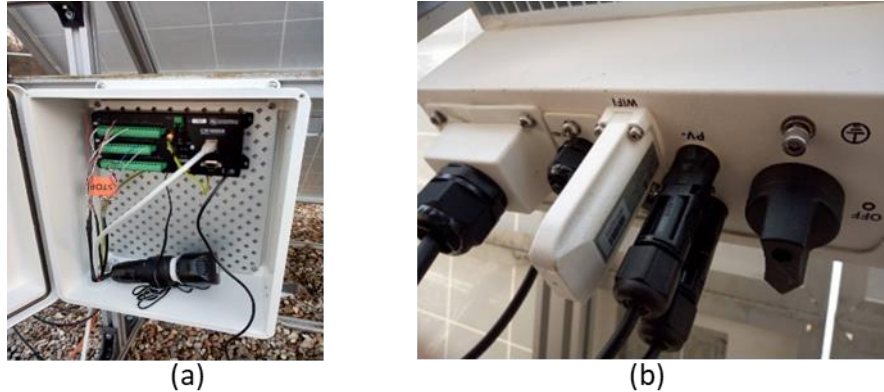
Figure 72 Vue des moyens d'acquisition pour les mesures d'irradiance et de température (a) et de transmission des mesures électriques de l'onduleur (b) (Février 2019)
