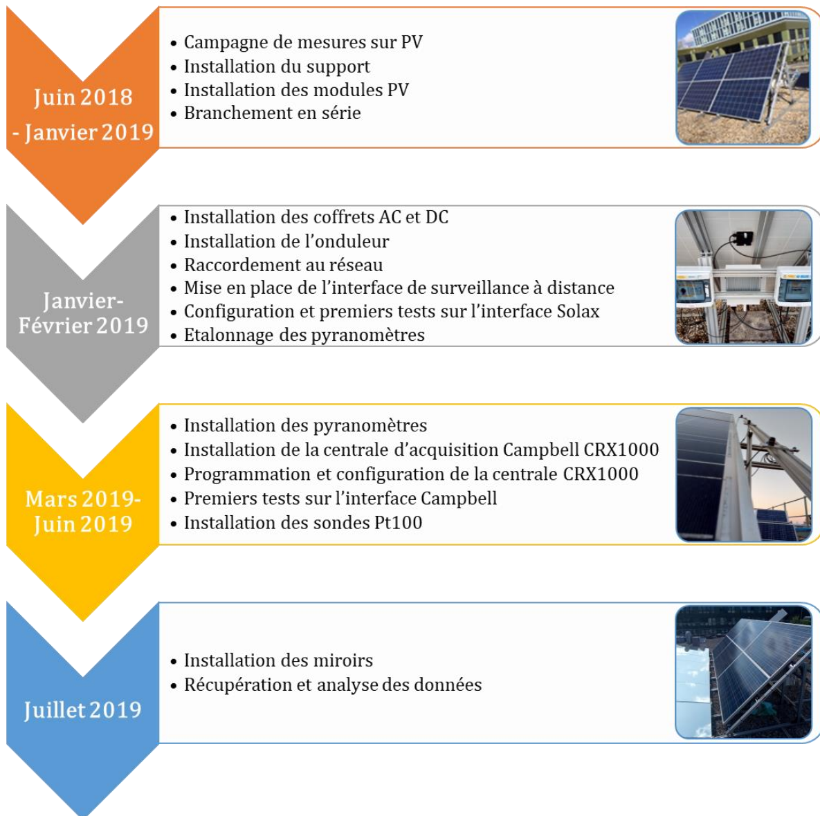
Figure 68 Processus de l'installation GeePSunSite au cours du temps
