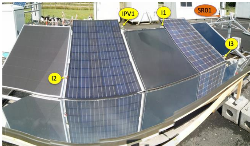
Figure 20 Banc de caractérisation équipé de capteurs d'irradiance et de réflecteurs plans, observatoire SIRTA. Les capteurs marqués en jaune correspondent à des photodiodes SOLEMS RG100.
