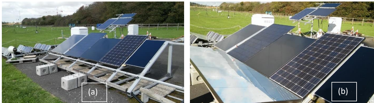
Figure 57 Banc de caractérisation photovoltaïque, (a) avant ajout de réflecteurs et (b) après ajout de réflecteurs
