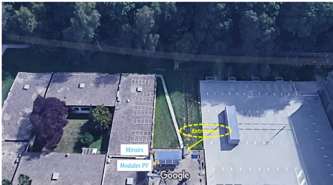
Figure 78 Effet d'ombrage de la forêt en face de l'installation GeePSunSite
