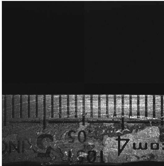
FIGURE 2.5 – Exemple d'une image de mire utilisée pour convertir les pixels en mm.
