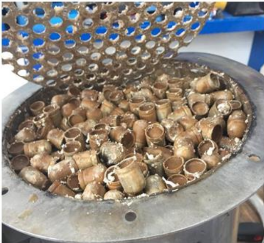
Figure 216 : Images de l'échangeur-stockeur après les 8000 cycles
