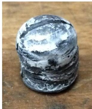
Figure 222 : Matrice GNE imprégnée avec de la paraffine après l'étude de vieillissement
