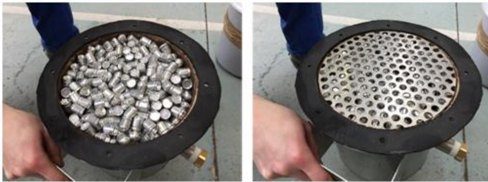
Figure 214 : Images de l'échangeur-stockeur remplie de cylindres de matériau composite
