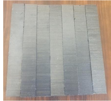
Figure 78 : Image d'une plaque de matériau composite GNE-MCP découpée en plusieurs morceaux et collée.
