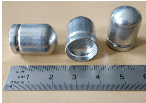
Figure 213 : Capsule en aluminium contenant le matériau composite
