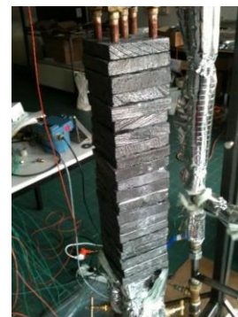
Figure 182 : Photo de l'échangeur contenant les plaques de matériau composite traversées par cinq tubes.
