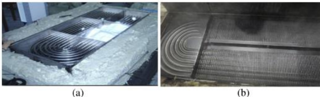
Figure 53 : (a) échangeur tubulaire sans ailettes, (b) échangeur tubulaire avec ailettes [86].
