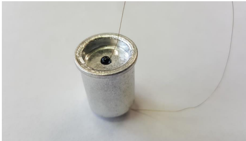
Figure 169 : Image du matériau composite encapsulé avec de l'aluminium instrumenté à cœur par un thermocouple.
