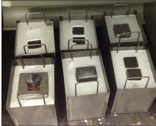
Figure 73 : Image des bacs remplis de paraffine et des plaques de GNE.
