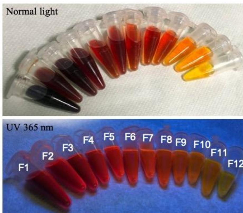
Figure 2.17 : Les différentes fractions séparées sous lumière blanche (haut) et sous excitation UV à 365 nm.
