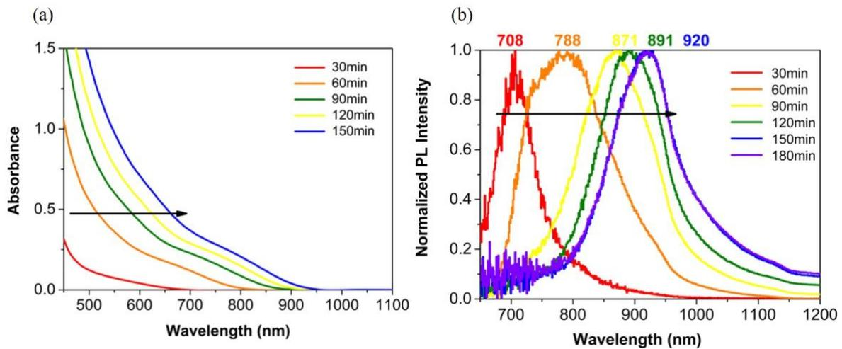
Figure 4.6 : (a) Spectres d'absorption et (b) de PL des différentes aliquotes prélevées à différents temps de réaction.
