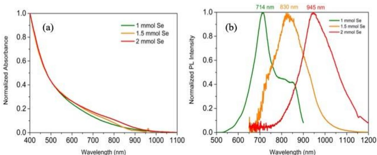
Figure 2.7 : (a) Spectres d'absorption et (b) d'émission des QDs cœur de Cu-In-S-Se synthétisés avec 1, 1.5 et 2 mmol de Se.
