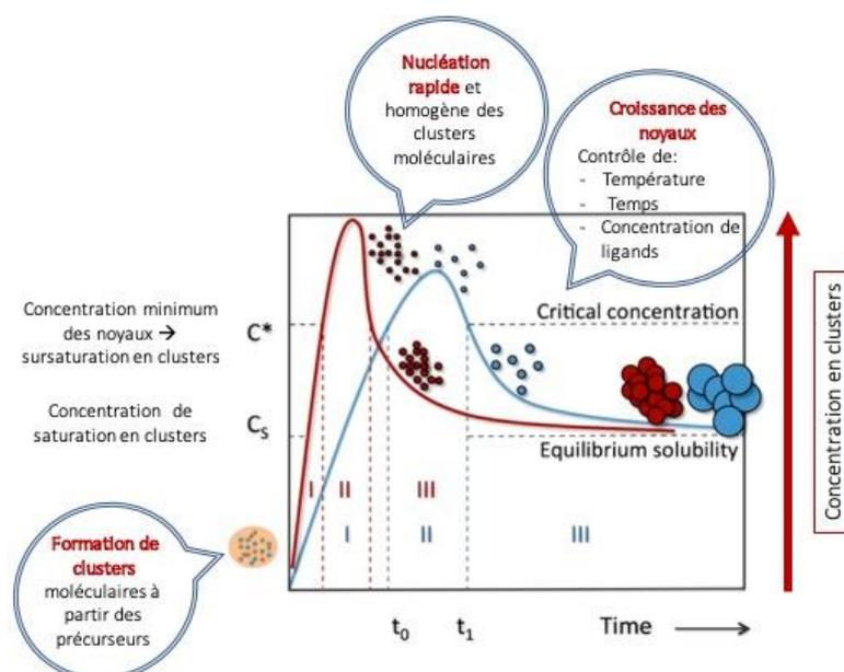
Figure 1.10 : Représentation schématique adaptée <sup>29,65</sup> du modèle proposé par LaMer et Dinegar. La phase de nucléation doit être rapide afin de réduire la concentration des clusters. Si cette dernière augmente pendant la réaction, il peut y avoir nucléation pendant la phase de croissance, provoquant une perte de la monodispersité.
