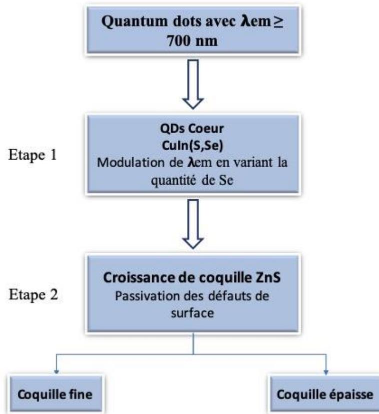
Figure 2.5 : Schéma de la synthèse organique de Cu-In-S-Se/ZnS.
