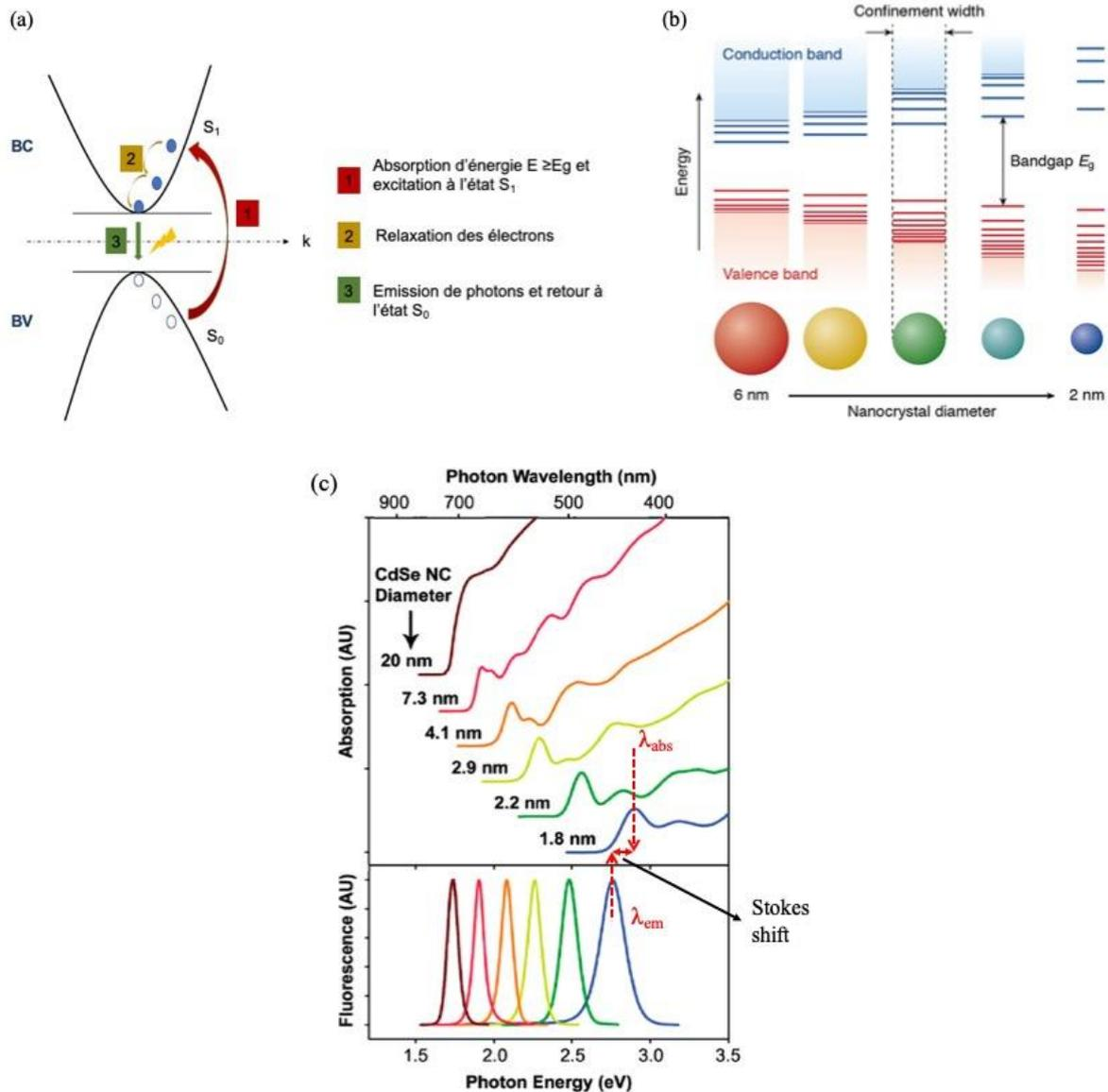
Figure 1.2 : (a) Illustration des chemins possibles empruntés par l'électron excité dans un QD. (b) Variation du gap  $E_g$  des QDs et la couleur de l'émission en fonction de leur taille.<sup>19</sup> (c) Exemple de variation de spectres d'absorption et d'émission de QDs de CdSe de différentes tailles et le décalage de Stokes.<sup>20</sup>
