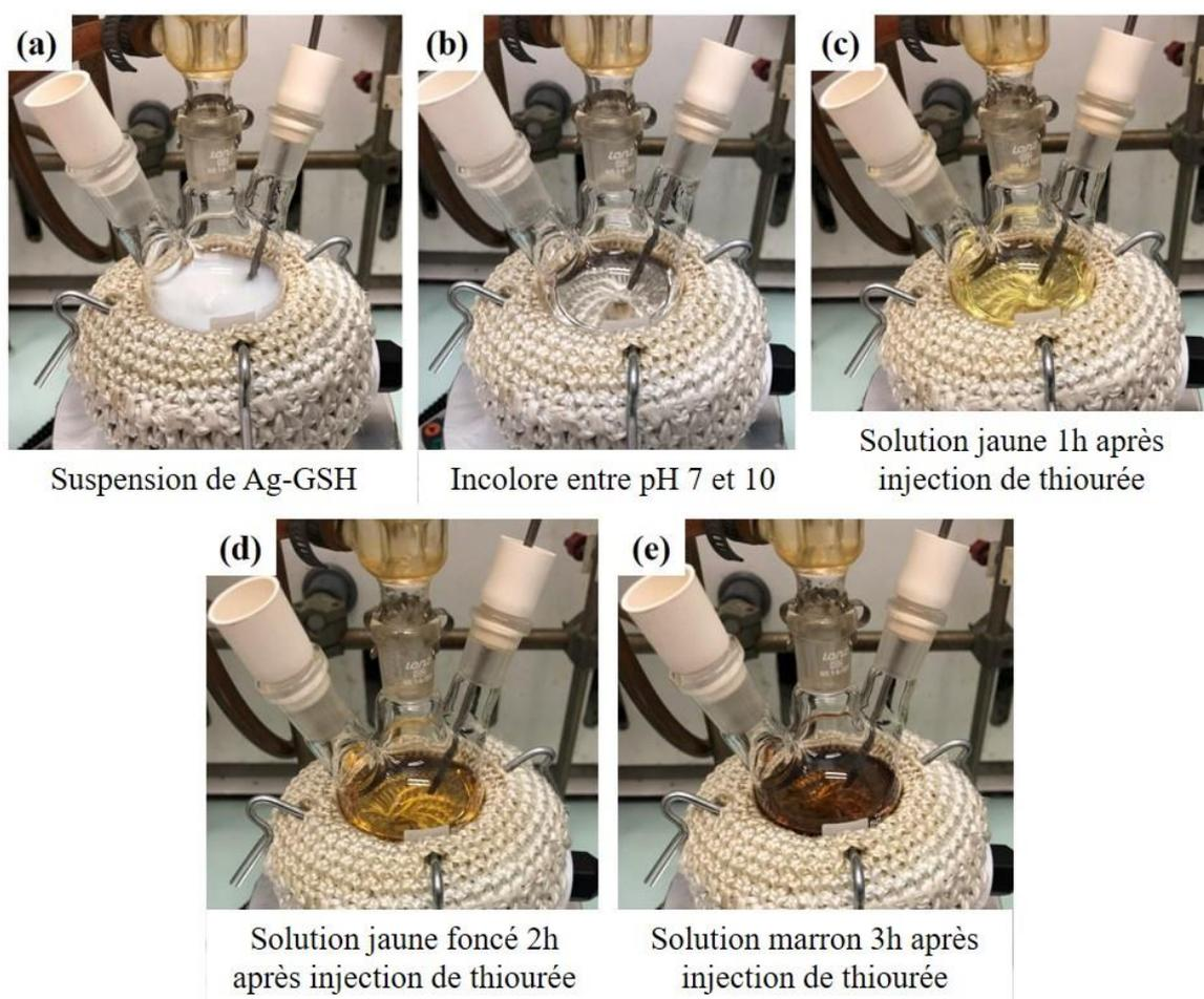
Figure 4.5 : (a) Le mélange Ag-GSH est une suspension blanche qui devient (b) incolore lorsque le pH est ajusté entre 7 et 10. Après l'ajout de la thiourée à  $100^\circ C$ , la solution change de couleur. Elle est (c) jaune 1h après l'injection, (d) jaune foncé après 2h et (e) marron après 3h de réaction.
