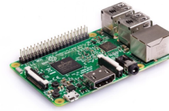
(b) Un Raspberry Pi-3 implémentant un ARM Cortex-A53
