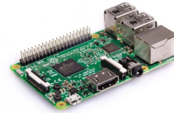
(b) Un Raspberry Pi-3 implémentant un ARM Cortex-A53
