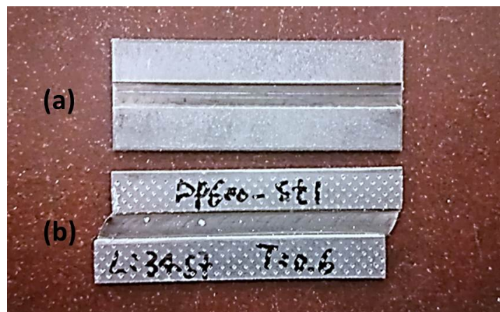
FIGURE 3.7 – Cisaillement simple (DL) pour DP600 : (a) éprouvette avant essai ; (b) éprouvette après essai.
