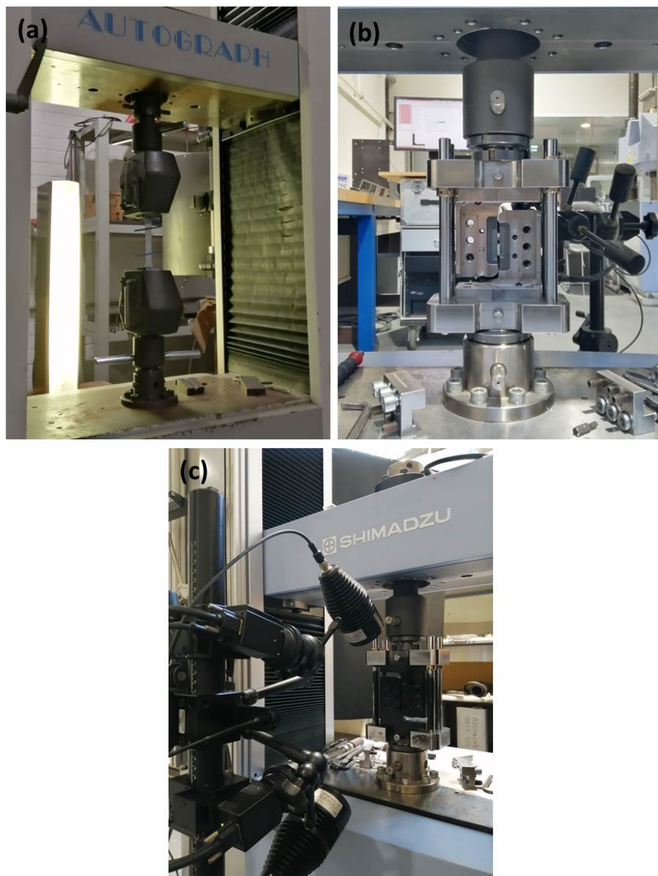
FIGURE 3.4 – Appareils d'essai de caractérisation des matériaux : (a) Essai de traction uniaxiale ; (b) Machine de traction avec le montage d'essai de cisaillement ; (c) Système de mesure de la déformation ARAMIS-GOM.
