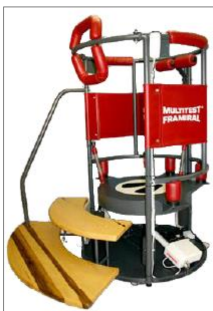
Figure 4.6. : Plateforme de force Multitest Equilibre Framiral®. Le dispositif est composé d'un plateau stable. Les pieds du sujet doivent être positionnés dans les empreintes visibles afin d'assurer une position conforme aux normes de l'AFP. Une barrière de protection assure la sécurité du sujet.
