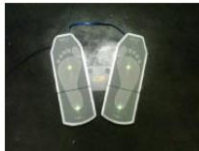
Figure 4.4. : Plateforme TechnoConcept®. Le dispositif est composé de deux sabots. Le sujet a pour consigne de positionner un pied sur chaque sabot sans chaussures.
