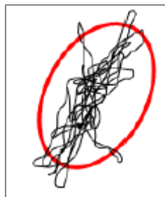
Figure 4.5. : Surface du statokinésigramme. Le tracé noir correspond au déplacement du CdP. La surface de ce déplacement est représentée par le tracé rouge.
