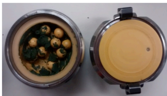
Figure 5.4 : bol de broyage (20 mL) et son couvercle, en zircone avec dix billes et le pigment
