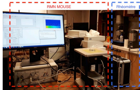
Figure 4.14 : installation de la RMN MOUSE dans laboratoire de rhéologie (SIMM, ESPCI) afin de réaliser les mesures en parallèle de relaxométrie et de rhéologie (rhéomètre (RS600))
