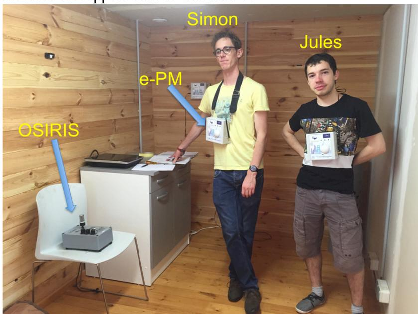
**Figure 26 : Photographie à l'intérieur d'un des deux chalets du démonstrateur de Sense-City avec les capteurs e-PM accrochés autour du cou et le positionnement de l'instrument de référence (OSIRIS)**
