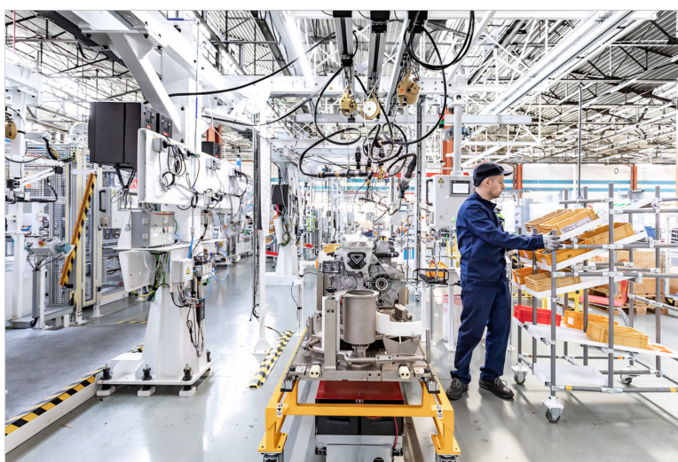
FIGURE 5.8 – Flux des produits sur AGV (source : Groupe PSA)
