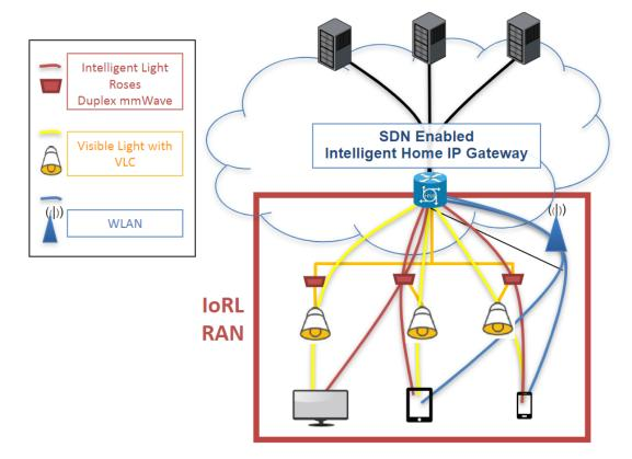
Figure B.7: Architecture réseau du projet IoRL
