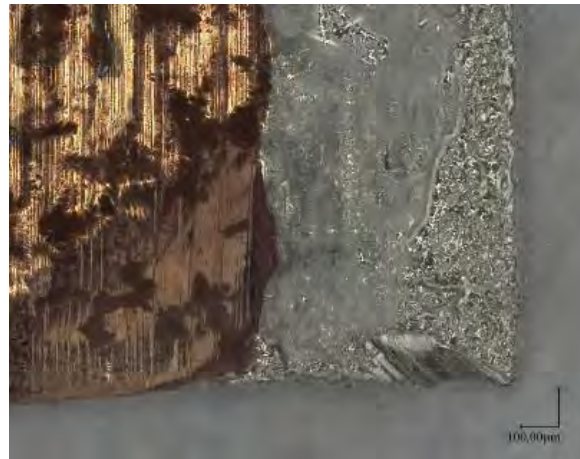
Figure 2.36 – Visualisation au microscope numérique (x200) de l’hétérogénéité du dépôt (a) et de l’aluminium attaqué (b)
