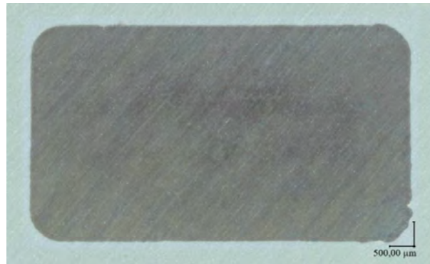
Figure 2.55 – Image au microscope numérique (x200) de la membrane après remplissage par électrodéposition de cuivre
