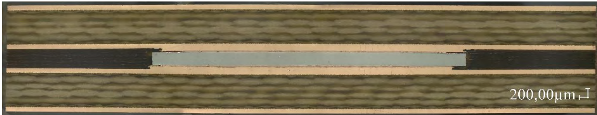
Figure 3.25 – Recomposition en deux dimensions par microscope numérique (x100) de la coupe micrographique d'une puce interconnectée dans la longueur
