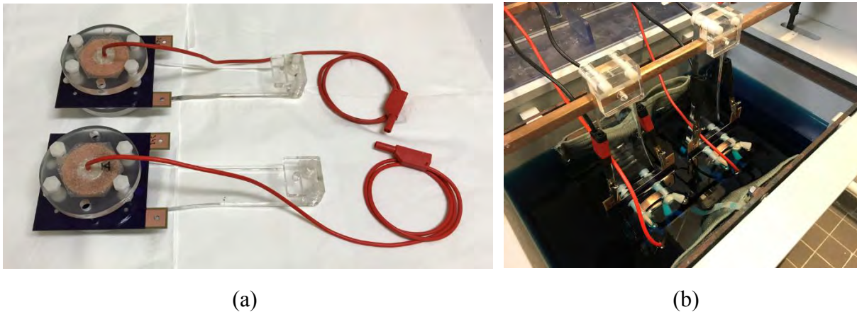
Figure 2.74 – Montage de deux cellules électrolytiques (a) suivit de l'étape d'électrodéposition (b)
