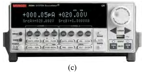
Figure 2.22 – Caractéristiques générales du Keithley 2612A (a) avec diagramme quatre quadrants en fonction de la forme d'onde (b) et photographie de l'appareil (c)
