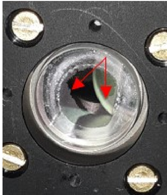
Fig. III.6 Image de l'intérieur du PMO-2D supérieur. La poudre s'accumule sur le hublot du poussoir
