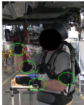
(a) Exemple de placement des centrales sur les membres supérieurs du porteur pour une activité bras en l'air
