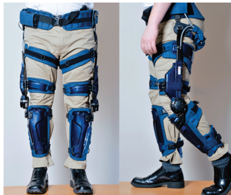
FIGURE 2.8 – Exosquelette d’assistance à la flexion des jambes : Keeogoo, B-Temia [3]
