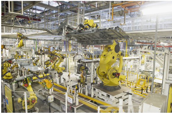
(a) Poste automatisé de soudure de la caisse, site de Sevel-Nord
