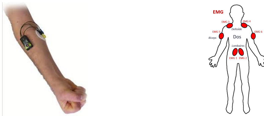
(a) Capteur SEMG, comprenant les électrodes et le boîtier de communication sans fil Captiv
