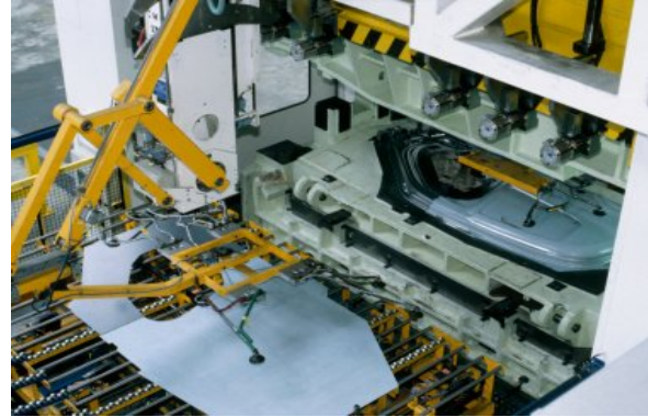
(b) Découpe automatisée des tôles par presse hydraulique
