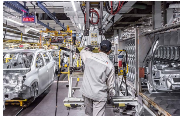
(b) Poste de montage des portes brutes sur la caisse avant peinture, site de Mulhouse
