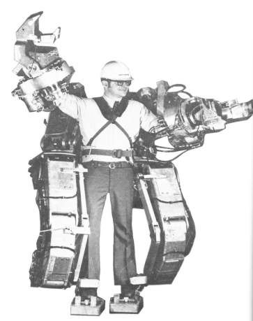
(c) Hardiman I combinaison mécanique, R. Mosher 1960 [36]
