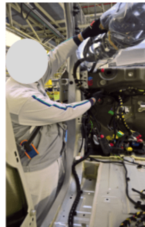
(b) Transport et mise en place du faisceau principal
