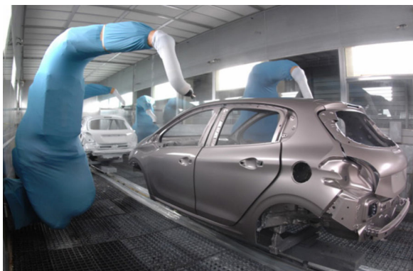
(a) Poste robotisé de peinture de la caisse, site de Poissy
