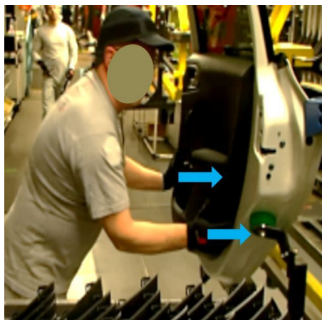
FIGURE 2.17 – Configuration de l'opérateur lors de l'application de l'effort nécessaire au clipsage des garnitures de porte
