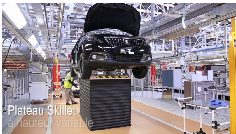
FIGURE 1.11 – Exemple de Skillet à hauteur variable, largement employé au sein du groupe PSA.
