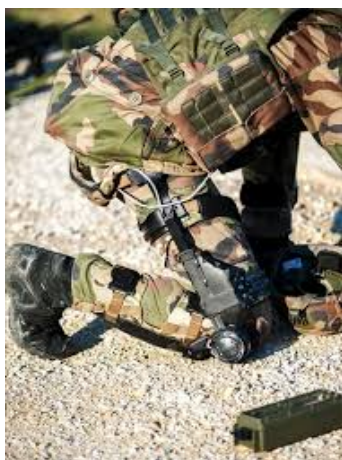
(a) Dermosquelette , assistance à la marche et à la flexion des jambes, Safran [45]
