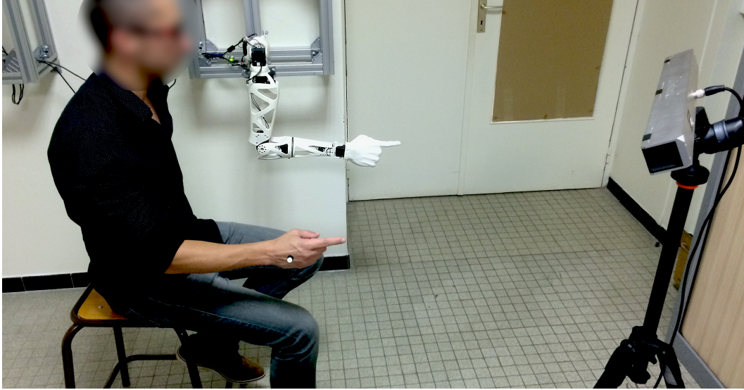
FIGURE I.3 – Exemples de postures générées par IKPy pour atteindre la même position cible, mais avec différents points de départ pour la résolution.
