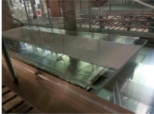
**Figure 9** : Dispositif utilisé pour chauffer les échantillons de matériau dans le cadre des essais de désorption
