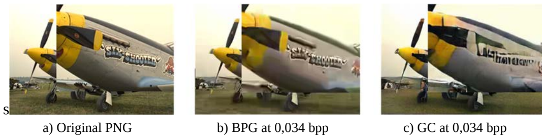
Figure 4.10 : Re-création de détails par la compression générative. Le texte présent dans l'image est préservé par une compression BPG pure (au milieu) mais est complètement remplacé par le réseau GAN (à droite). (Source : [Agustsson19])
