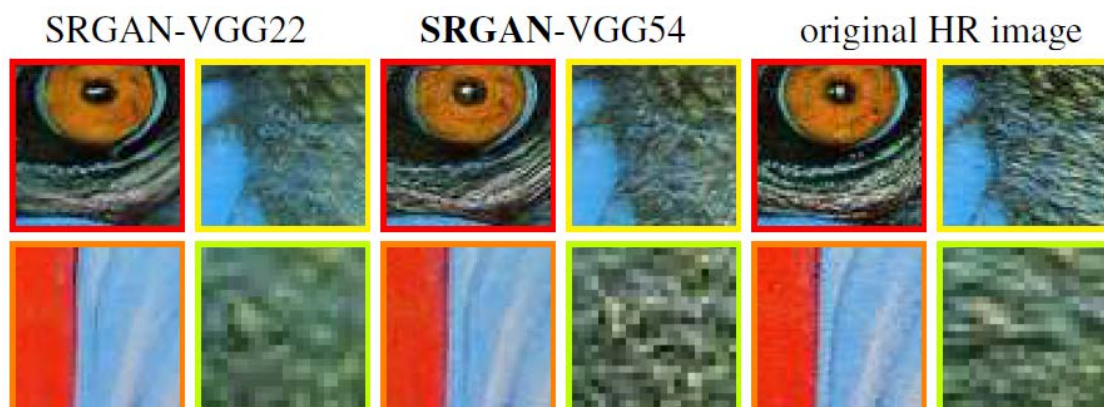
Figure 4.8 : Illustration des différences de détails obtenus via le SRGAN par utilisation respectivement du VGG22 et 54 (Source : [Ledig17])
