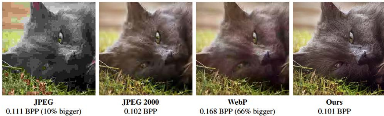
Figure 4.4 : Comparaison visuelle entre JPEG, JPEG2000, WebP et WaveOne à débits équivalents (Source : [Rippel17])
