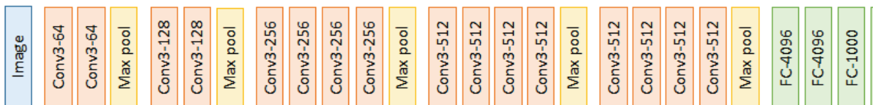
Figure 5.2 : Architecture du réseau VGG19 utilisé pour la perte VGG
