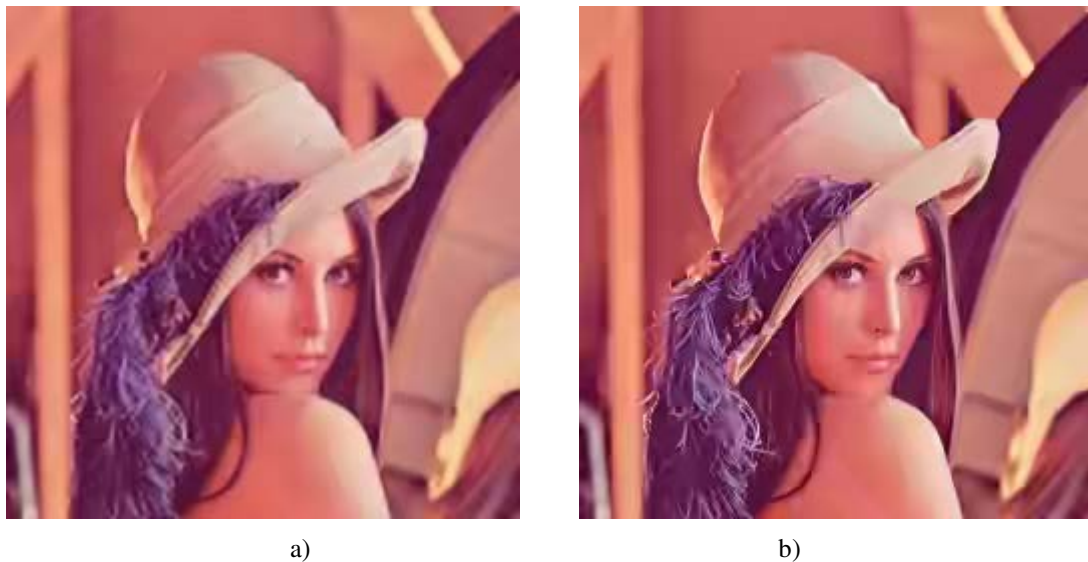
Figure 3.17 : Comparaison Lena à 2,1 ko, a) Pipeline BPG+SRCNN, b) BPG seulement
