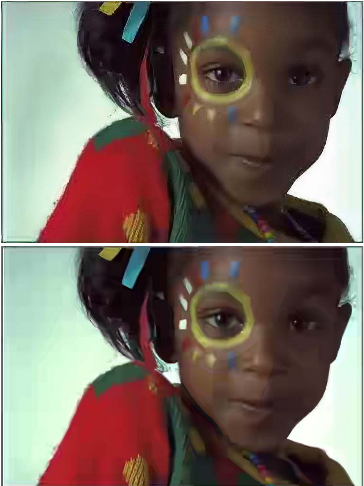
Figure 5.4 : Comparaison SRGAN + BPG (en haut) et BPG seul à 1,9 ko (0,04 bpp) (en bas)
