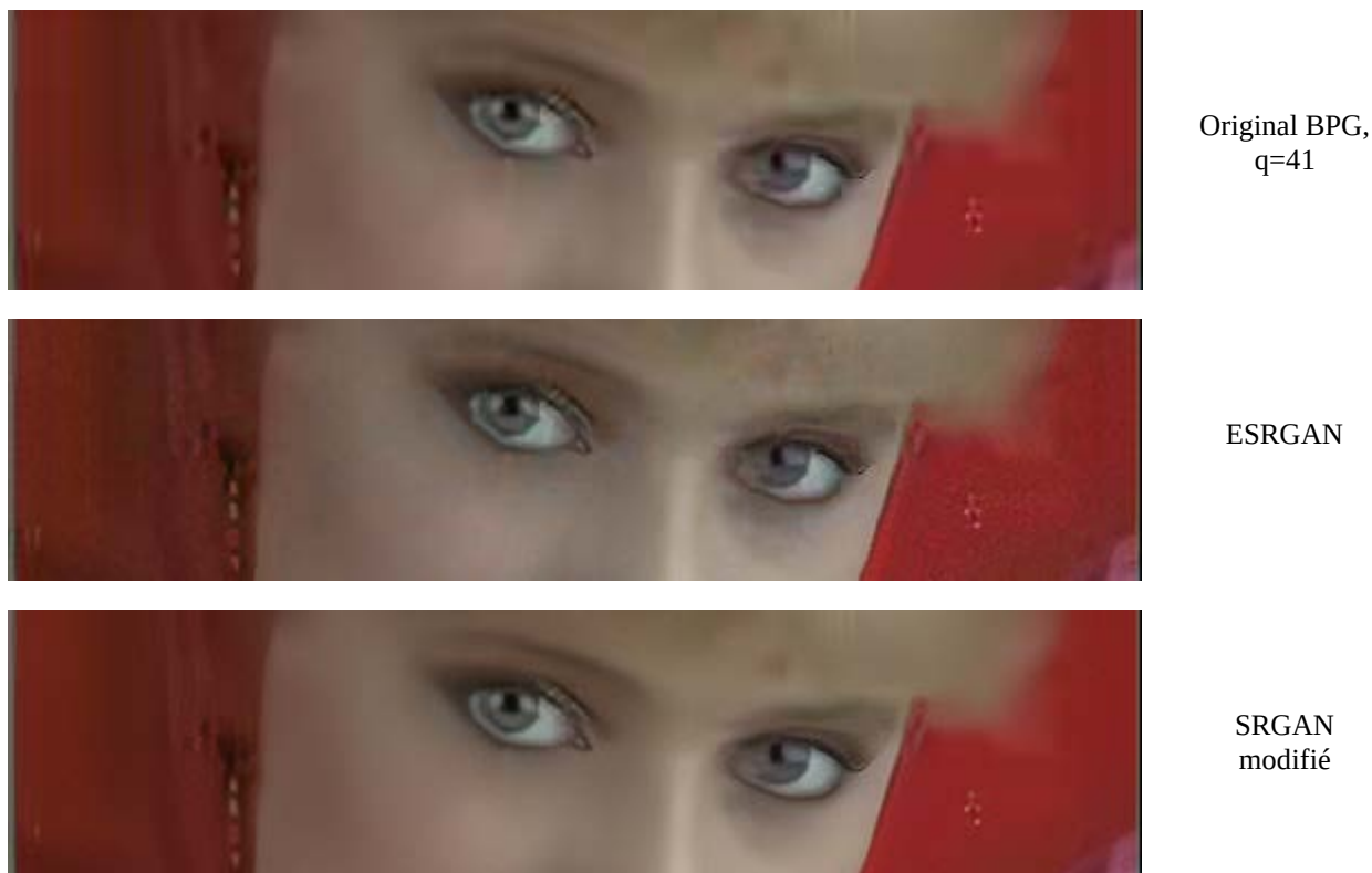
Figure 5.34 : Exemple de Reconstruction \times 1_{\text{gen}} par SRGAN moins fidèle mais plus agréable visuellement
