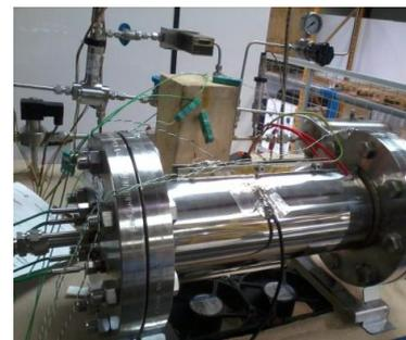
Figure B2.2 : Schéma du réacteur à brides utilisé avec la disposition des thermocouples.
