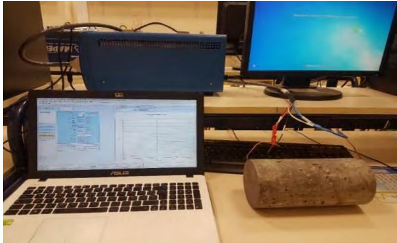
Figure II-11 : Dispositif de mesure de résistivité au potentiostat sur un béton B1
