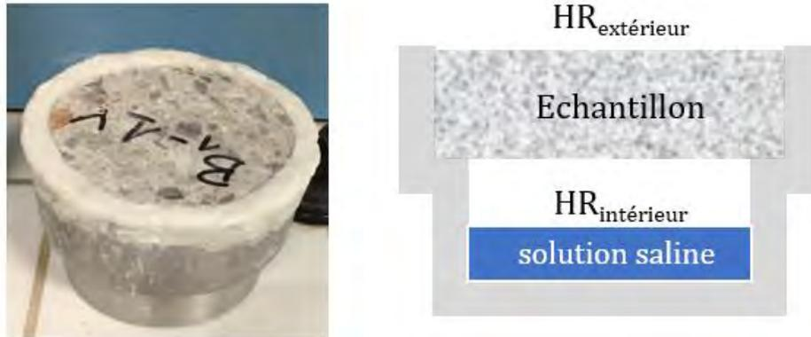
Figure II-8 : Dispositif de mesure de la perméabilité à la vapeur (essai à la coupelle)
