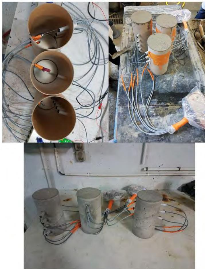
Figure II-17 : Mise en place des sondes noyées dans le béton B1
