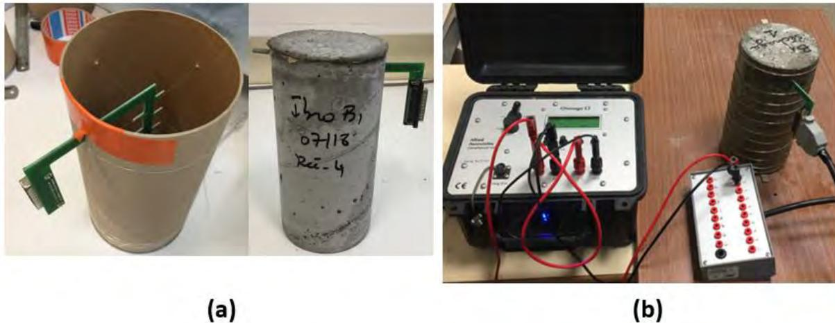
Figure II-25 Instrumentation (a) et dispositif de mesure de résistivité (a) avec capteurs en circuit imprimé
