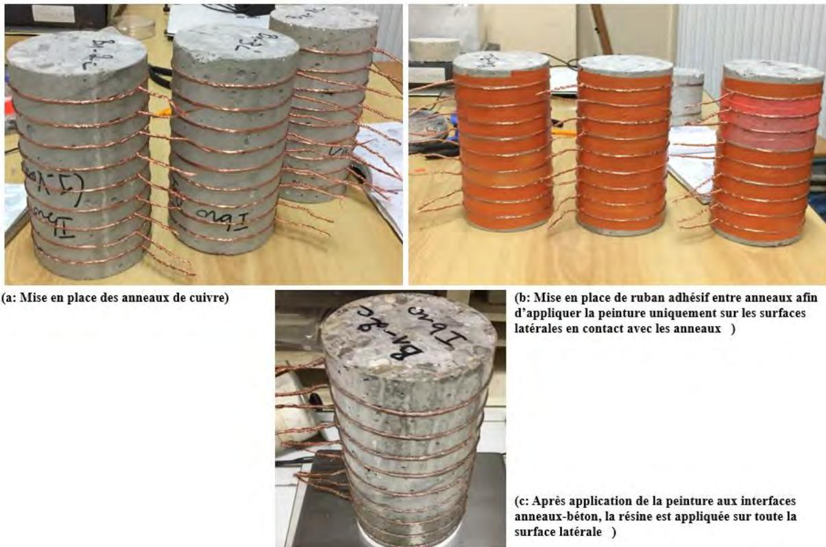
Figure II-18 : Mise en place des anneaux de cuivre (a), préparation des éprouvettes pour l'application de la peinture conductrice (b) et dispositif final (c).
