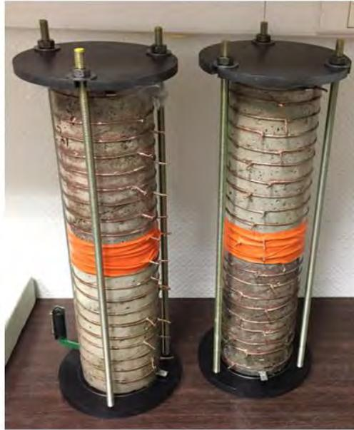
**Figure II-31 : Dispositif mis en place pour suivre le rééquilibrage hydrique entre deux matériaux initialement en conditions de saturation différentes**
