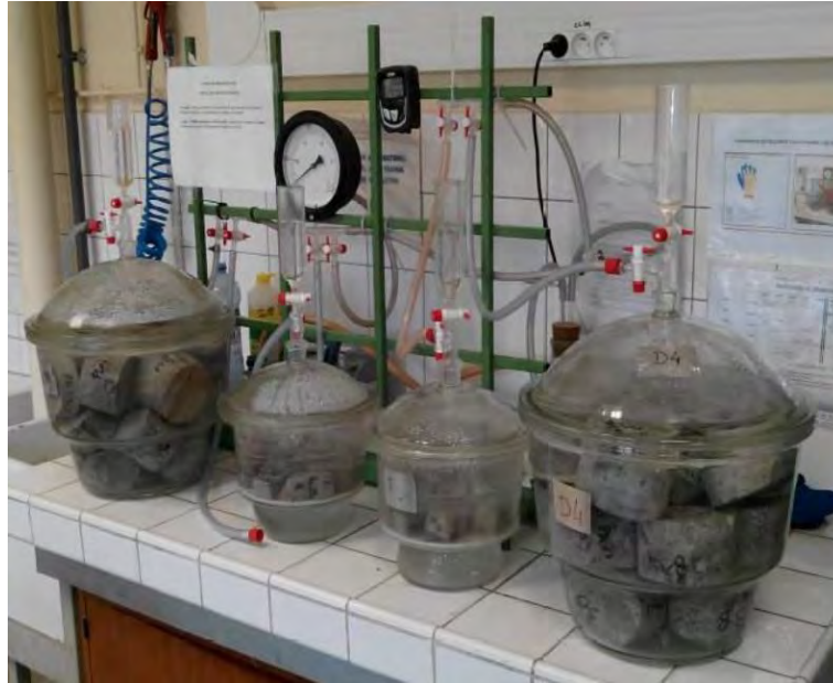
Figure II-4 : Banc de mise sous vide des échantillons pour la détermination de la porosité à l'eau
