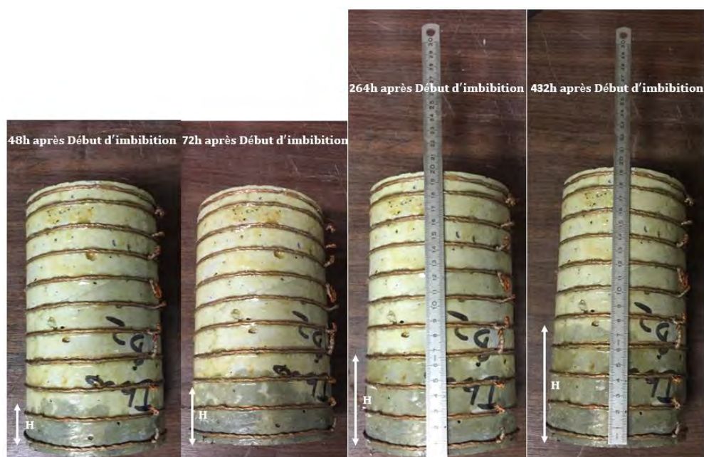
Figure III-38 : Exemple d'observation du front de remontée capillaire sur un béton B2 initialement à l'état sec et de hauteur 20 cm
