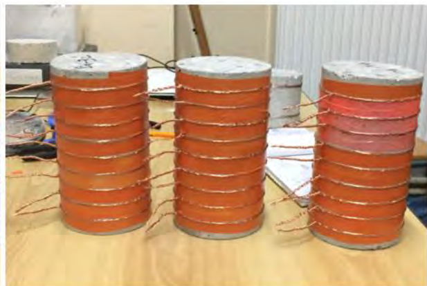
(b: Mise en place de ruban adhésif entre anneaux afin d'appliquer la peinture uniquement sur les surfaces latérales en contact avec les anneaux )
