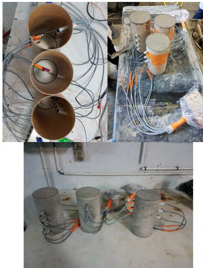
Figure II-17 : Mise en place des sondes noyées dans le béton B1
