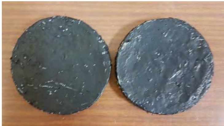
Figure II-13 : Caoutchouc enrobé de peinture conductrice
