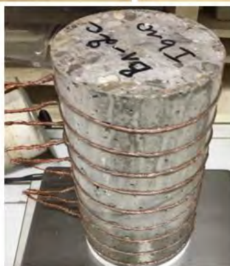
Figure II-18 : Mise en place des anneaux de cuivre (a), préparation des éprouvettes pour l'application de la peinture conductrice (b) et dispositif final (c).
