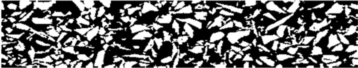
Figure 38 : Illustration de l'image permettant le calcul de la porosité du dépôt
