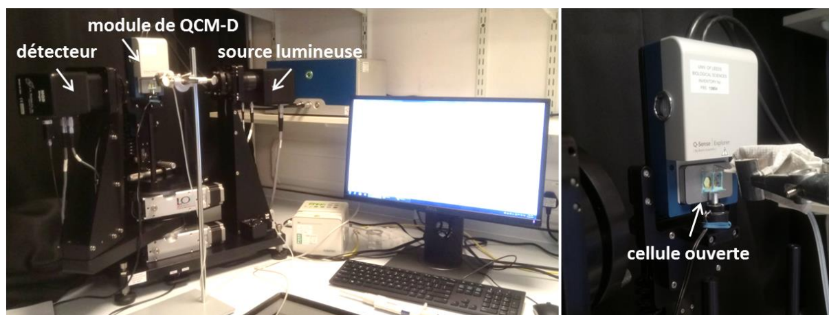
Figure 39 : Dispositif de SE couplée à la QCM-D développé par R. Richter et utilisé à l'Ecole des Sciences biomédicales de l'université de Leeds. Un module ouvert de QCM- D a été modifié avec une chambre transparente et placé à la verticale de telle sorte à pouvoir injecter les solutions.
