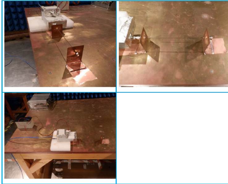
FIGURE 5.13 – Installation du conducteur interne nu sans blindage
