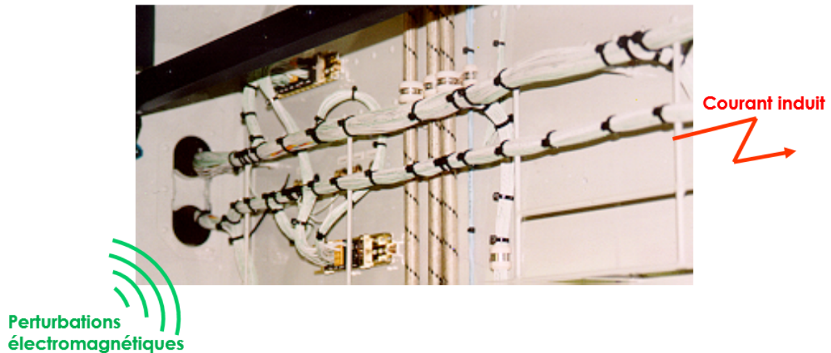
FIGURE 1.4 – Les harnais sont des récepteurs privilégiés du rayonnement électromagnétique ambiant [3]
