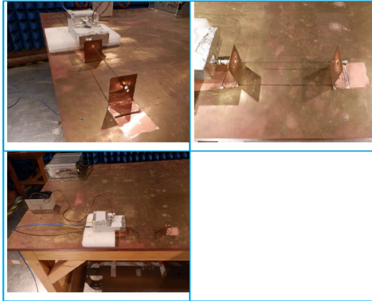
FIGURE 5.13 – Installation du conducteur interne nu sans blindage
