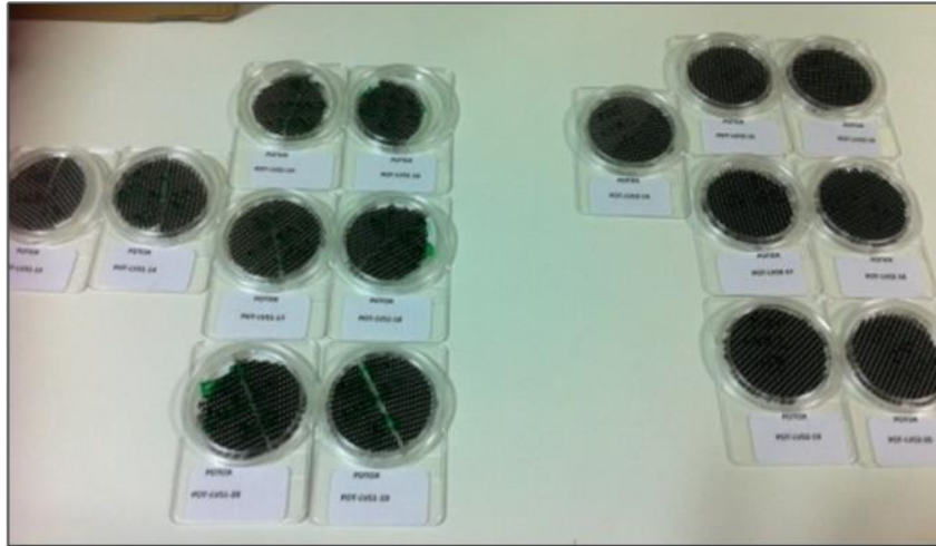
Figure 40 : Photographie des filtres en Téflon avec des PM 2.5 , récupérés après 24 h sur la station AIRPARIF, provenant des préleveurs Leckel (Projet POTOX).
