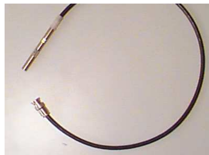
Figure A3.2 - Photographie d'un connecteur pour chambre à fission de 8 mm de diamètre
