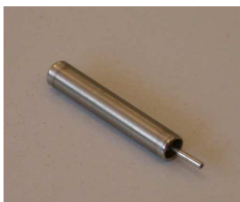
Figure 5.1 - Photographie d'une chambre à fission de 4 mm de diamètre
