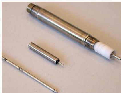
Figure A2.1 - Photographie des chambres à fission de 1.5 mm, 4 mm et 8 mm de diamètre fabriquées par le SPEx/LDCI
