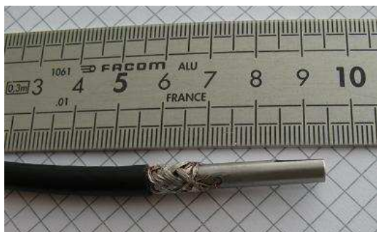
Figure A3.1 - Photographie d'un connecteur pour chambre à fission de 4 mm de diamètre
