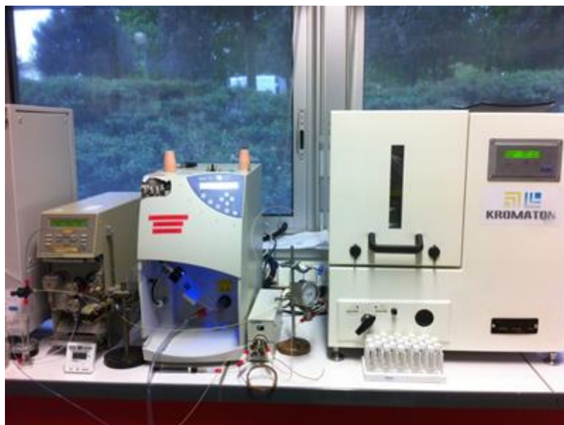
Figure 25 Photo de l'installation de CPC utilisée au laboratoire GEPEA de Saint-Nazaire
