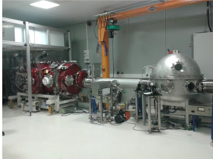
FIGURE 6 – Première salle blanche de CALVA montrant la cuve rouge, appelée Ferrarix, utilisée pour le banc sous-vide d'Exsqueeze, et la cuve grise dans laquelle se trouve le premier miroir de la cavité de filtrage de 50 m.
