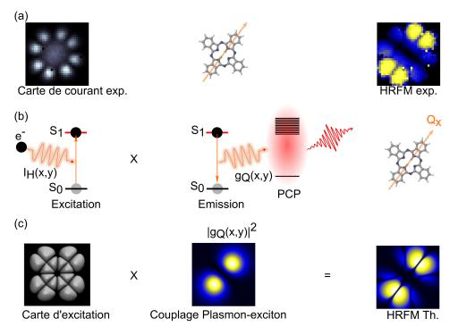
**Figure 1: Carte HRFM de la raie**  $Q_x$  **de fluorescence de la molécule de**  $H_2$ **Pc** (a) Carte de courant expérimentale, orientation du moment dipolaire de transition  $Q_x$  et carte HRFM de la raie  $Q_x$ . (b) Schèma representant le processus d'excitation par les électrons tunnels et le processus d'émission piloté par les plasmons de la pico-cavité. (c) Cartes théoriques d'excitation, d'émission et carte HRFM totale théorique.
