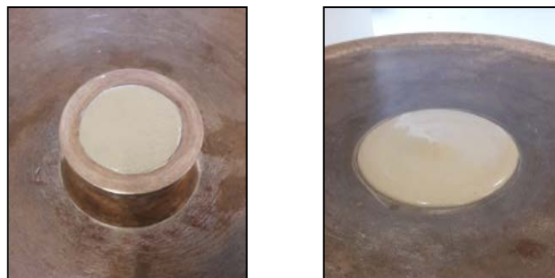
Figure 2.9: Mini-cône utilisé et un exemple d'un étalement de pâte
