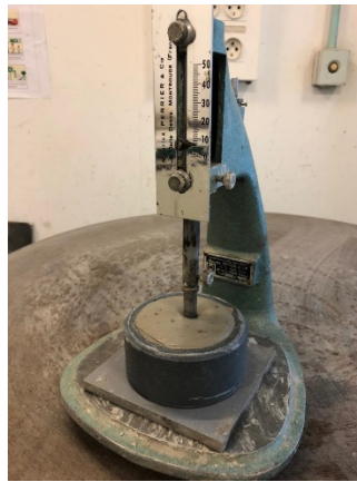
Figure 2.5: Appareil Vicat servant à déterminer la consistance normalisée
