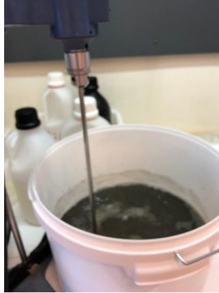
Figure 2.12: Lavage des sédiments à l'eau déminéralisée
