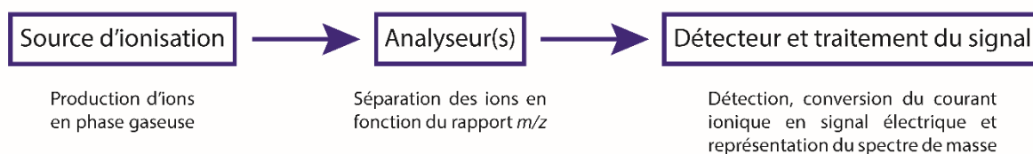
Figure II.3. Schéma basique d'un spectromètre de masse.
