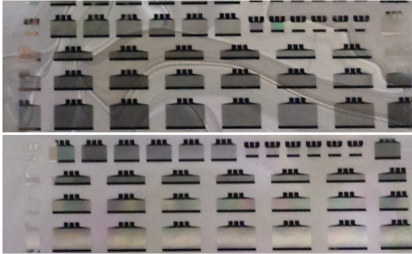
FIGURE 4.14 – Résonateurs sur STS après fabrication
