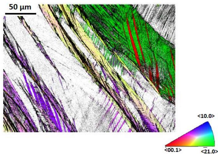
FIGURE 2.26 – Carte EBSD en mode IPF représentant les orientations cristallographiques selon les triangles standard d'un échantillon de Ti17 traité- $\beta$  déformé à 25°C et 1 s<sup>-1</sup>. Projection selon l'axe [001].
