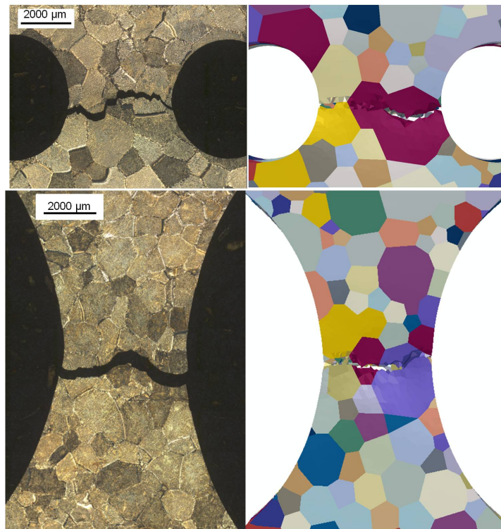
FIGURE 4.17 – Rupture intragranulaire des éprouvettes entaillées ( R_2 et R_8 ) de Ti17 \alpha + \beta déformées à 1 \text{ s}^{-1} et à 25^\circ\text{C} .
