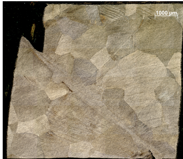
FIGURE 2.28 – Observation par microscope optique (en lumière polarisée) d'une bande de cisaillement adiabatique après déformation d'un échantillon de Ti17 traité- \beta à 10 \text{ s}^{-1} et 25^\circ\text{C} .
