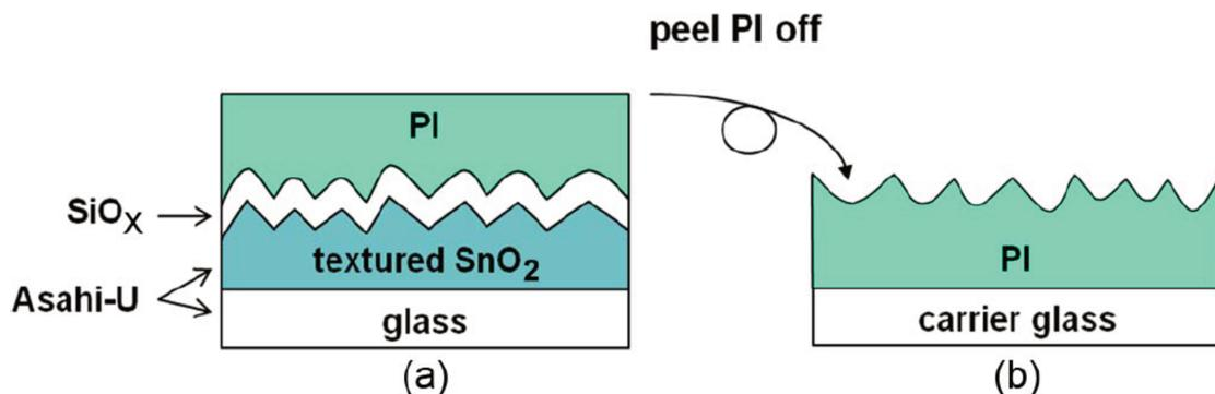
Figure 4-21. Processus de fabrication d'un substrat polyimide texturé : a) le substrat de polyimide est déposé sur un dispositif  $SiO_x$  + verre texturé et b) décollement du polyimide qui est collé sur un verre porteur [310].
