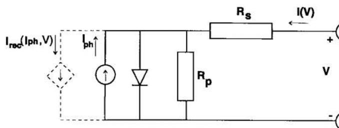
Figure 2-13. Circuit équivalent d'une cellule PIN a-Si:H [221].
