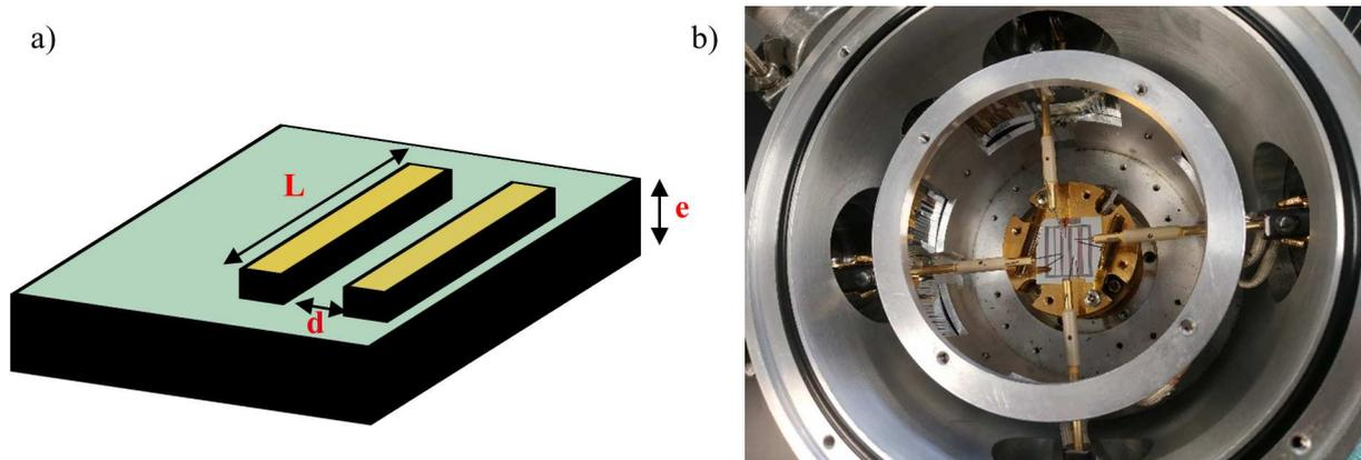
Figure 0-3. Mesure de photoconductivité : a) schéma de la couche mince et des électrodes métalliques et b) photo du montage de la mesure.
