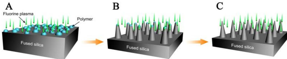
Figure 2-4. Illustration schématique du procédé de gravure [197].
