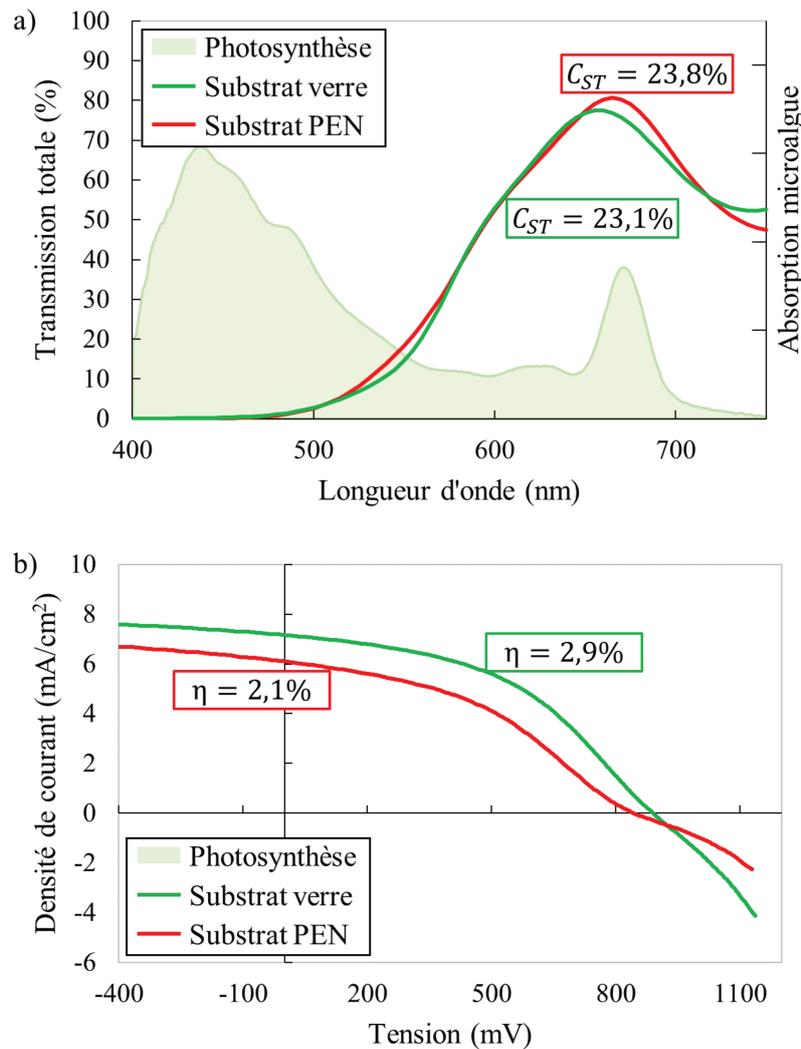
Figure 4-18. Comparaison des cellules PV déposées sur verre et PEN : a) transmissions totales et valeurs des critères de semi-transparence et b) densité de courant en fonction de la tension et rendements PV.
