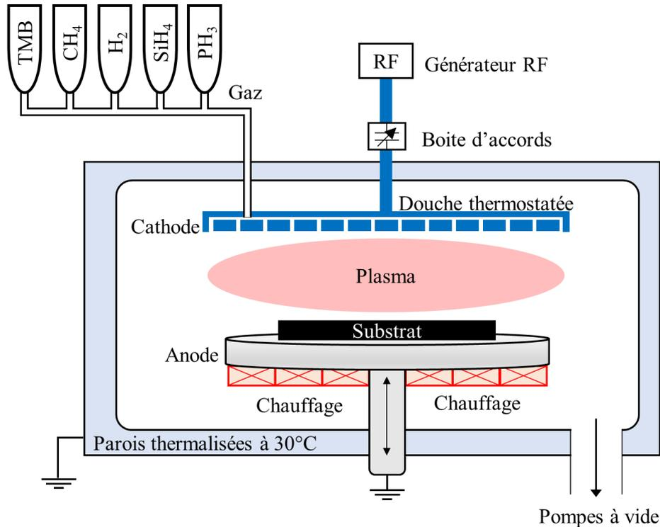
Figure 2-8. Schéma de principe du dépôt chimique en phase vapeur assisté par plasma.
