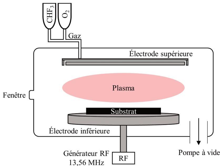
Figure 2-3. Schéma de principe de la gravure sèche RIE.
