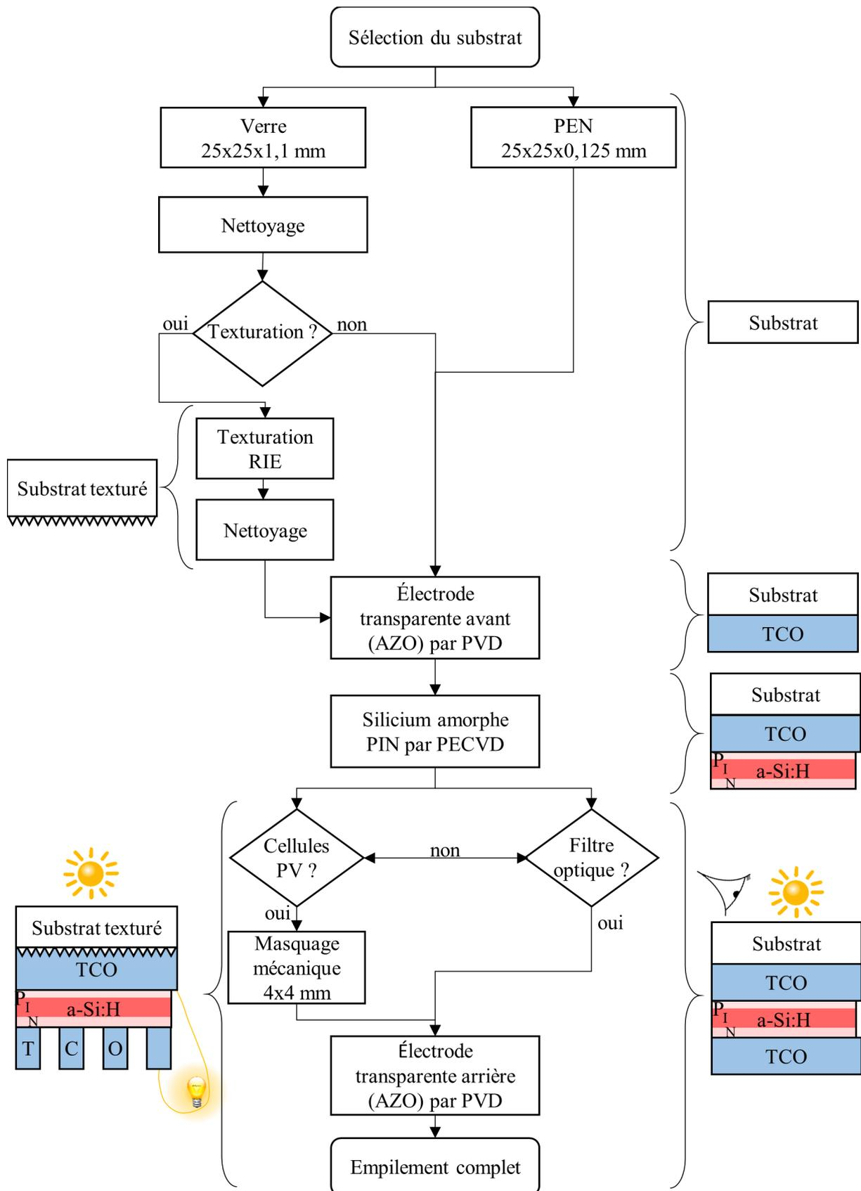
Figure 2-2. Logigramme retraçant les différentes étapes de la réalisation d'une cellule solaire en silicium amorphe hydrogéné.
