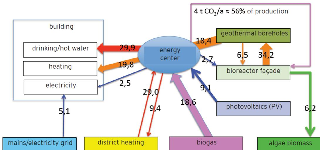
Figure 5-3. Diagramme de prévision du bilan énergétique annuel de la BIQ-House en MWh.an<sup>-1</sup> [321].
