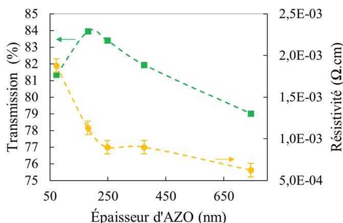
Figure 2-5. Évolution de la transmission (points verts) et de la résistivité (points jaunes) en fonction de l'épaisseur de la couche d'AZO.
