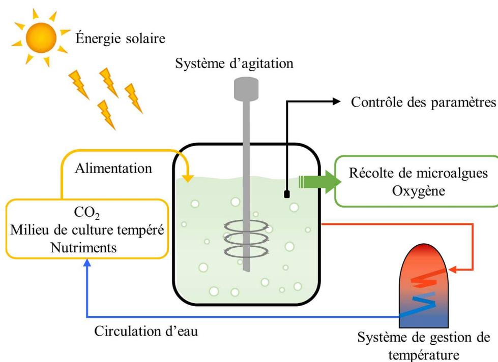
Figure 1-7. Schéma synthétique du fonctionnement d'un photobioréacteur.
