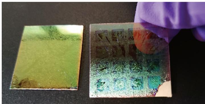
Figure 4-16. Cellules PV en silicium amorphe hydrogéné déposées sur un substrat en polycarbonate.
