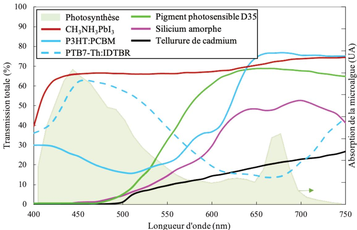
Figure 1-18. Comparaison des différents spectres de transmission à travers des cellules solaires semi-transparentes en pérovskite CH<sub>3</sub>NH<sub>3</sub>PbI<sub>3</sub> (rouge) [106], organique PTB7-Th:IDTBR (bleu pointillé) [107], organique P3HT:PCBM (bleu continu) [108], pigment photosensible D35 (vert) [109], silicium amorphe (rose) [110] et tellure de cadmium (noir) [111] par rapport à l'absorption des microalgues.
