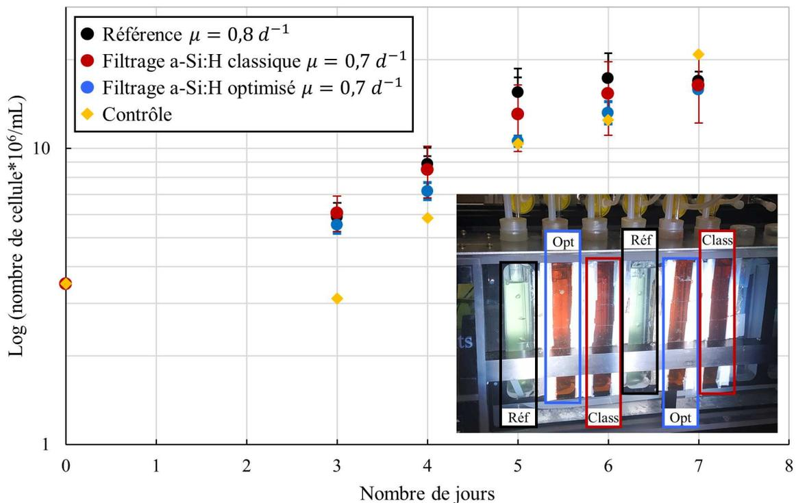
Figure 3-9. Courbes de croissance de microalgues et taux de croissance spécifique ( $\mu$  – cf. 2.4.3) avec une lumière non filtrée (référence en noir) ou une lumière filtrée par des cellules PV classiques (en rouge) et des cellules PV optimisées (en bleu). En insert, image du montage de croissance.
