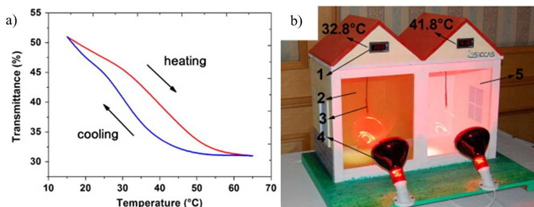
Figure 1-11. Gestion thermique par thermochromie [60] : a) hystérésis d'un film  $\text{VO}_2$  dopé W et b) exemple d'utilisation sous lampe infrarouge avec à gauche la température derrière un verre  $\text{VO}_2$  et à droite derrière un verre flotté vierge.
