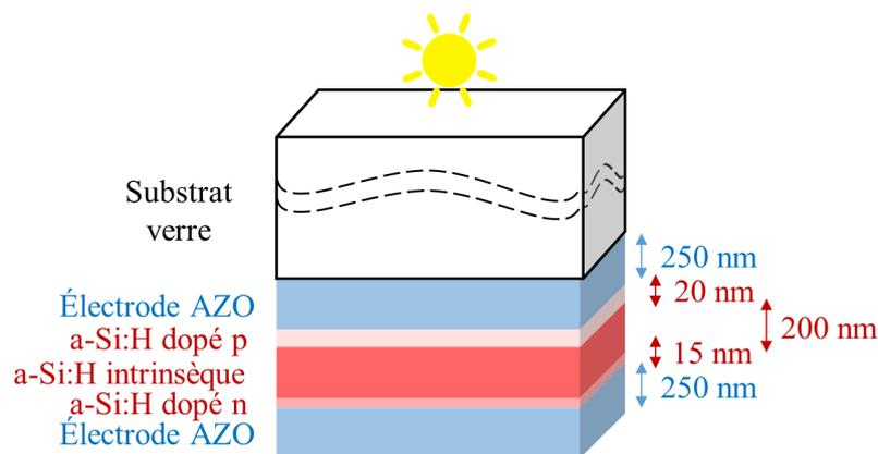
Figure 4-2. Composition des cellules solaires a-Si:H optimisées
