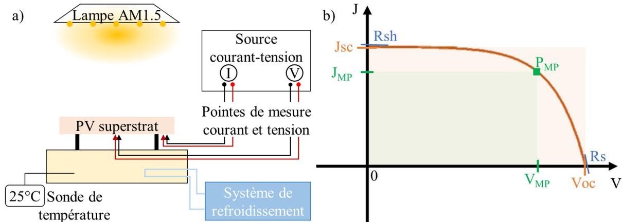
Figure 2-14. Mesure de courant-circuit  $J(V)$  : a) schéma du banc de mesure et b) caractéristique  $J(V)$  d'une cellule photovoltaïque.
