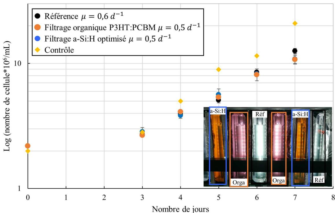
Figure 3-11. Courbes de croissance de microalgues et taux de croissance spécifique ( $\mu$ ) dont la lumière n'est pas filtrée (référence en noir) et dont la lumière est filtrée par des cellules PV a-Si:H (en bleu) et des cellules organiques P3HT:PCBM (en orange). En insert, image du montage de croissance.
