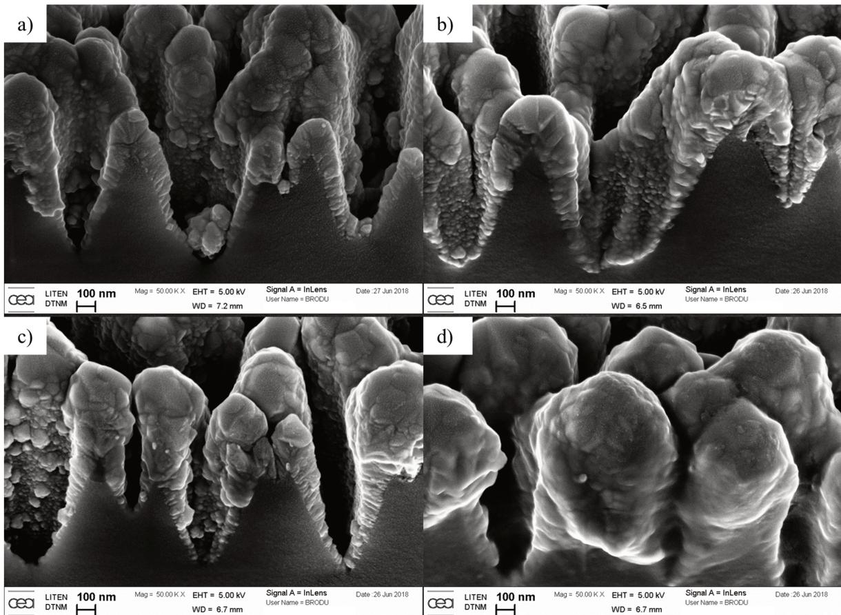
Figure 3-16. Croissance de différents dépôts d'AZO sur une texturation 3. a) 252 nm d'AZO –  $R_{\square} = 61 \Omega/\square$  ; b) 334 nm d'AZO –  $R_{\square} = 34 \Omega/\square$  ; c) 389 nm d'AZO –  $R_{\square} = 33 \Omega/\square$  et d) 506 nm d'AZO –  $R_{\square} = 21 \Omega/\square$ . Toutes les images sont au même grossissement.
