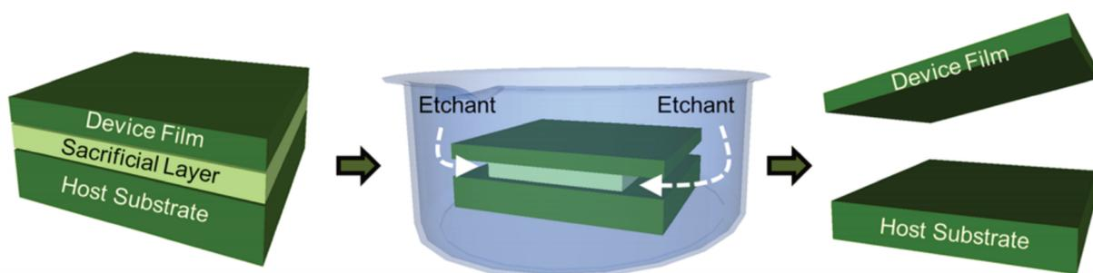
Figure 1-32. Schéma de principe de la « méthode de décollage épitaxial » où le transfert sur substrat souple est réalisé en utilisant une couche sacrificielle pour obtenir des couches minces sur des substrats flexibles [191].
