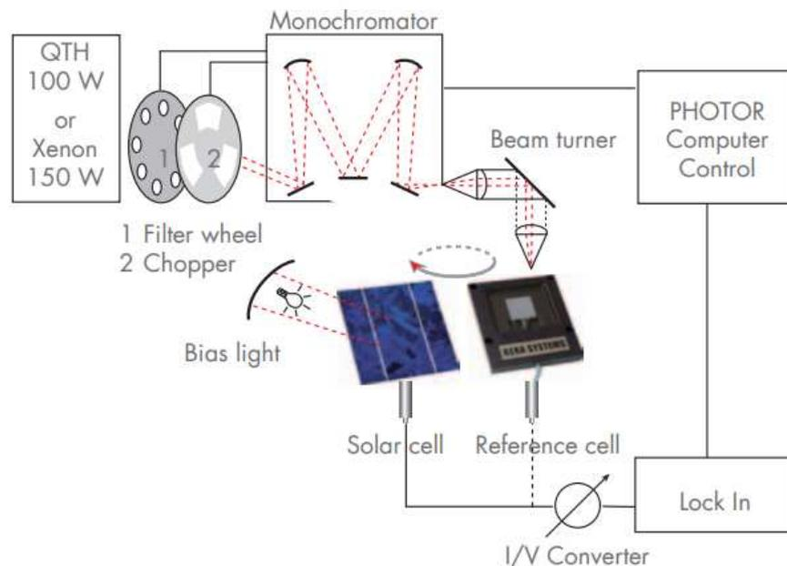
Figure 0-2. Schéma d'un système de caractérisation de réponse spectrale SPEQUEST [339].
