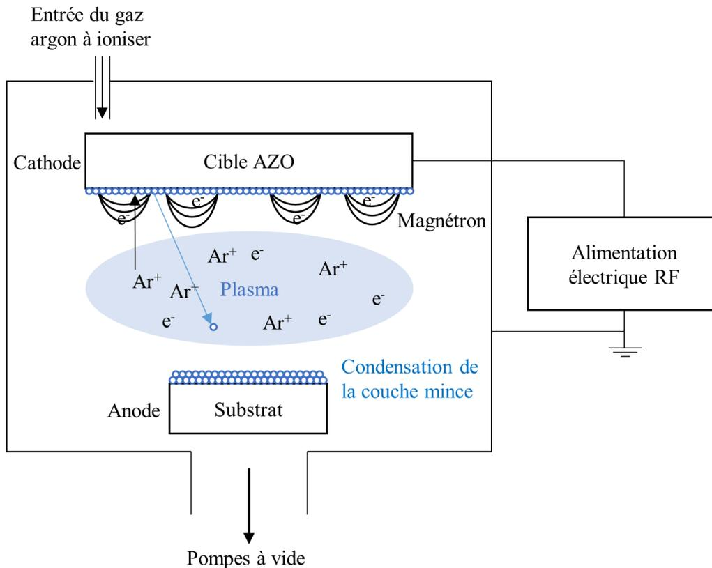
Figure 2-6. Schéma de principe de la pulvérisation cathodique magnétron.
