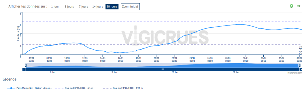
Figure 141 : Hauteur d'eau de la Seine mesurée à la station de Paris Austerlitz entre le 06/01 et le 05/02. Source : Vigicrue.
